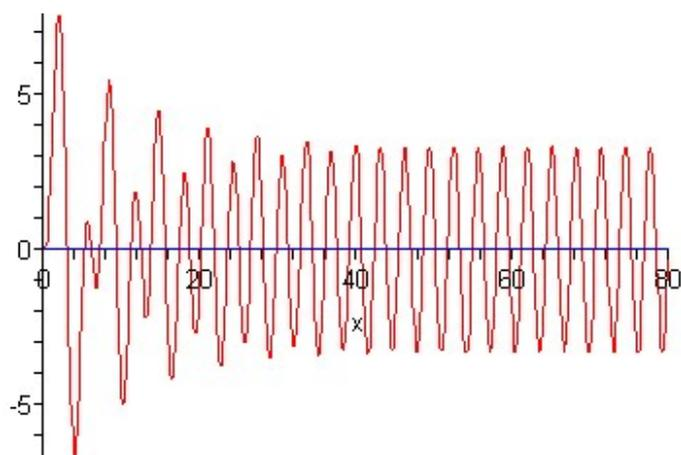
Pour  $\Omega = \omega_0$  (Résonance) l'amplitude de  $q$  est maximale lorsque le circuit est excité avec la pulsation propre.
