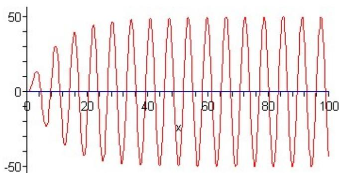
Dans le cas  $R = 0$  ( $\xi = 0$ ), on n'a plus d'effet d'amortissement (il n'y a plus de dissipation de l'énergie par effet Joule) et donc l'amplitude de la charge augmente indéfiniment
